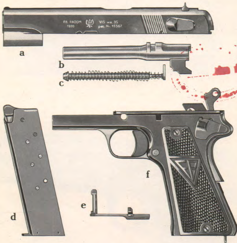
9 mm pistolet wz. 35 Vis częściowo rozłożony:
