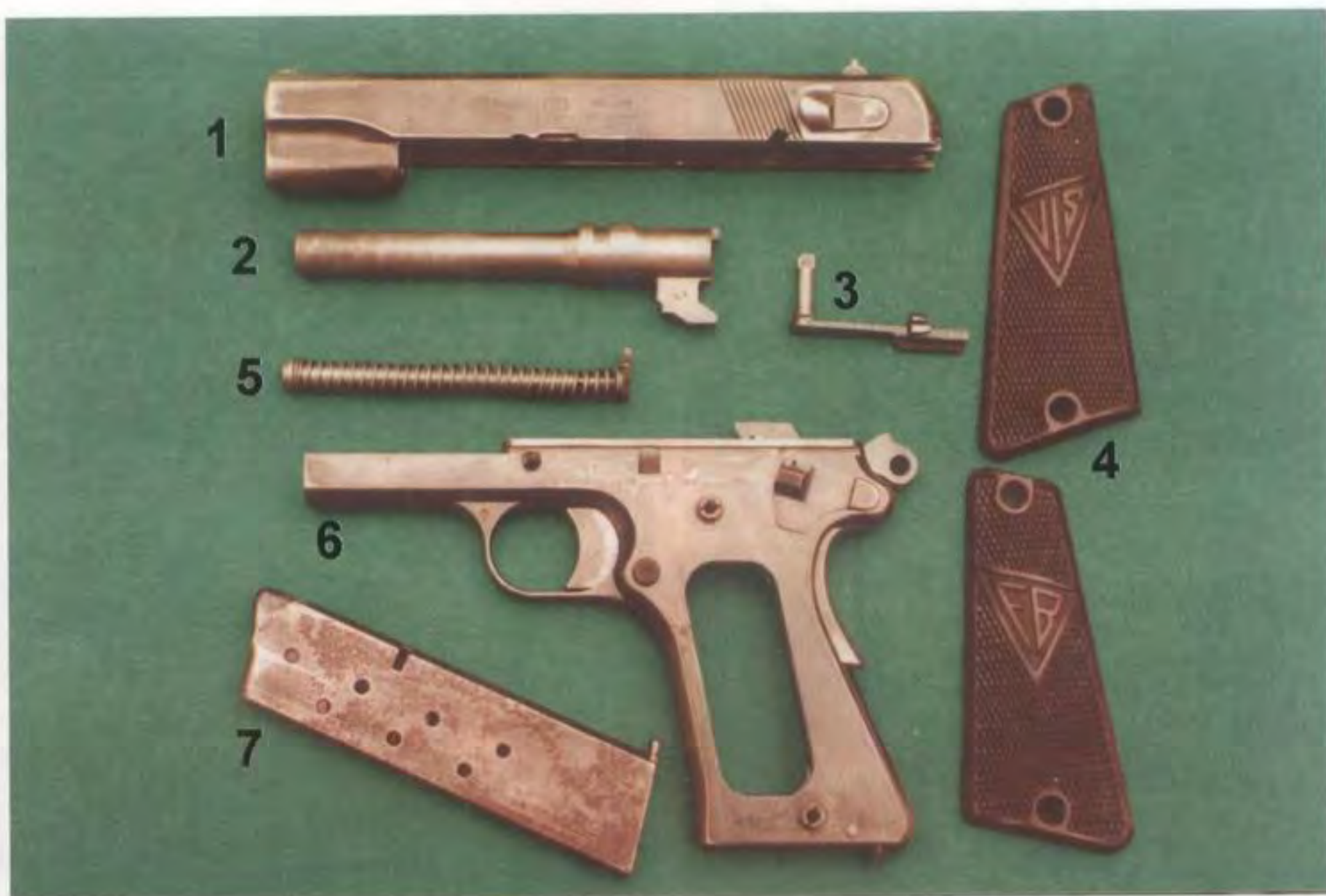
VIS wz. 1935 w stanie częściowo rozłożonym: 1 — zamek, 2 — lufa, 3 — zatrzask zamkowy, 4 — okładki chwytu, 5 — mechanizm powrotny, 6 — szkielet, 7 — magazynek (fot. A. Rawski)
