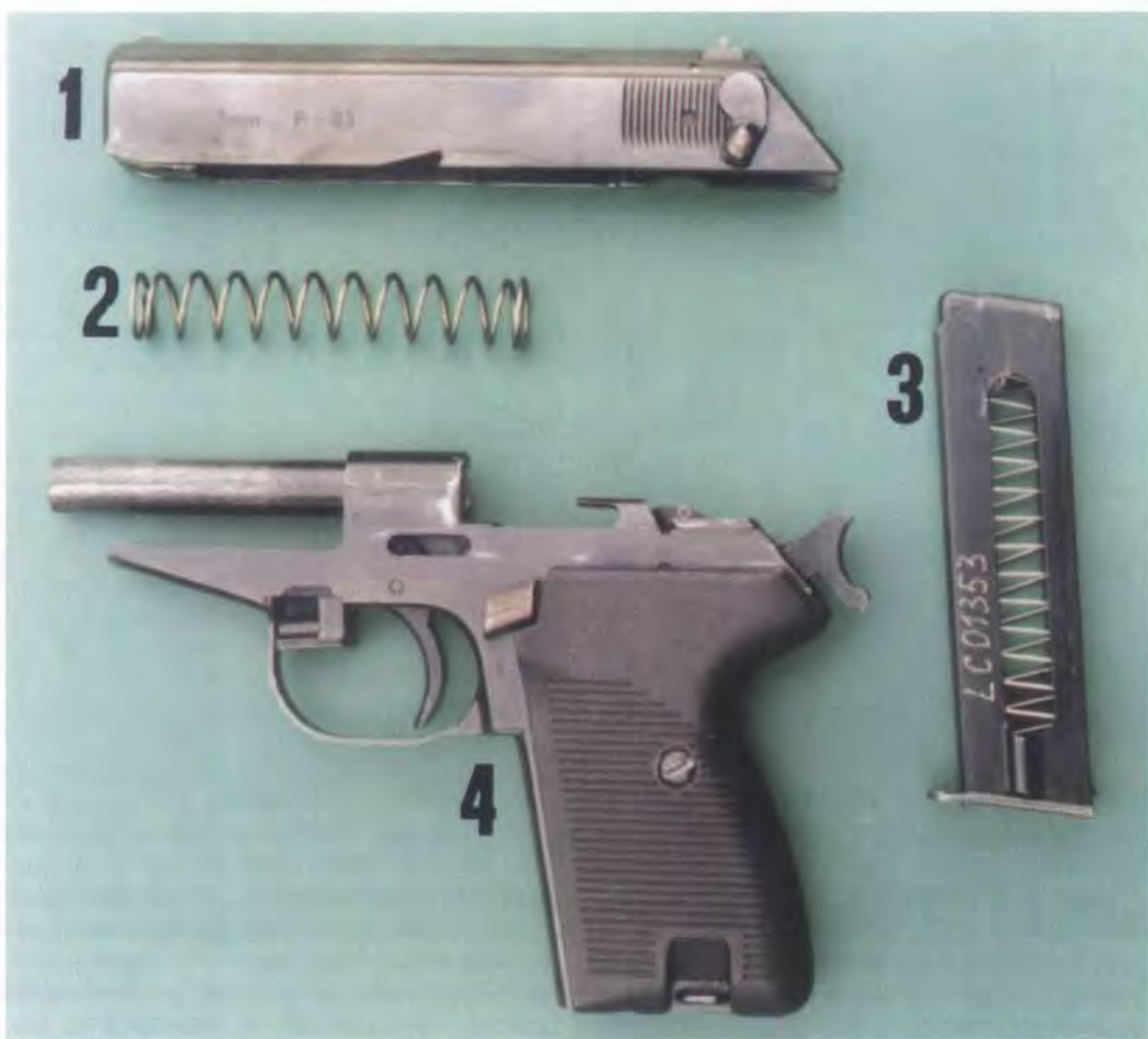
Pistolet wz. 1983, częściowo rozłożony: 1 — zamek, 2 — sprężyna powrotna, 3 — magazynek, 4 — szkielet z lufą
