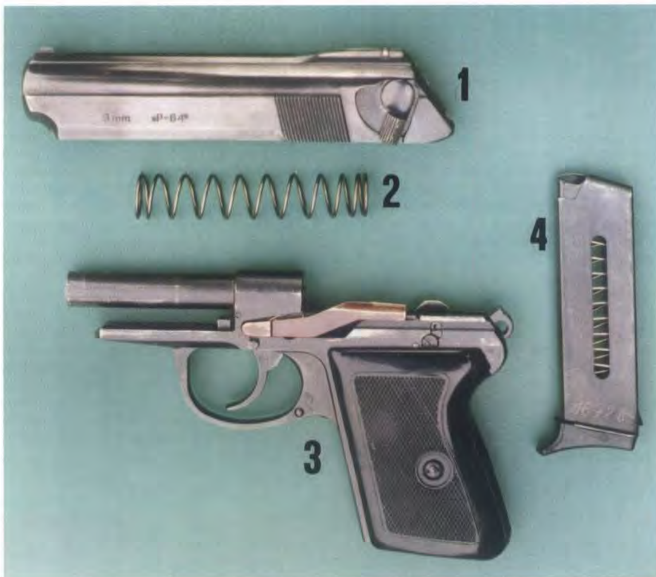
Pistolet wz. 1964, częściowo rozłożony: 1 — zamek, 2 — sprężyna powrotna, 3 — szkielet z lufą, 4 — magazynek
