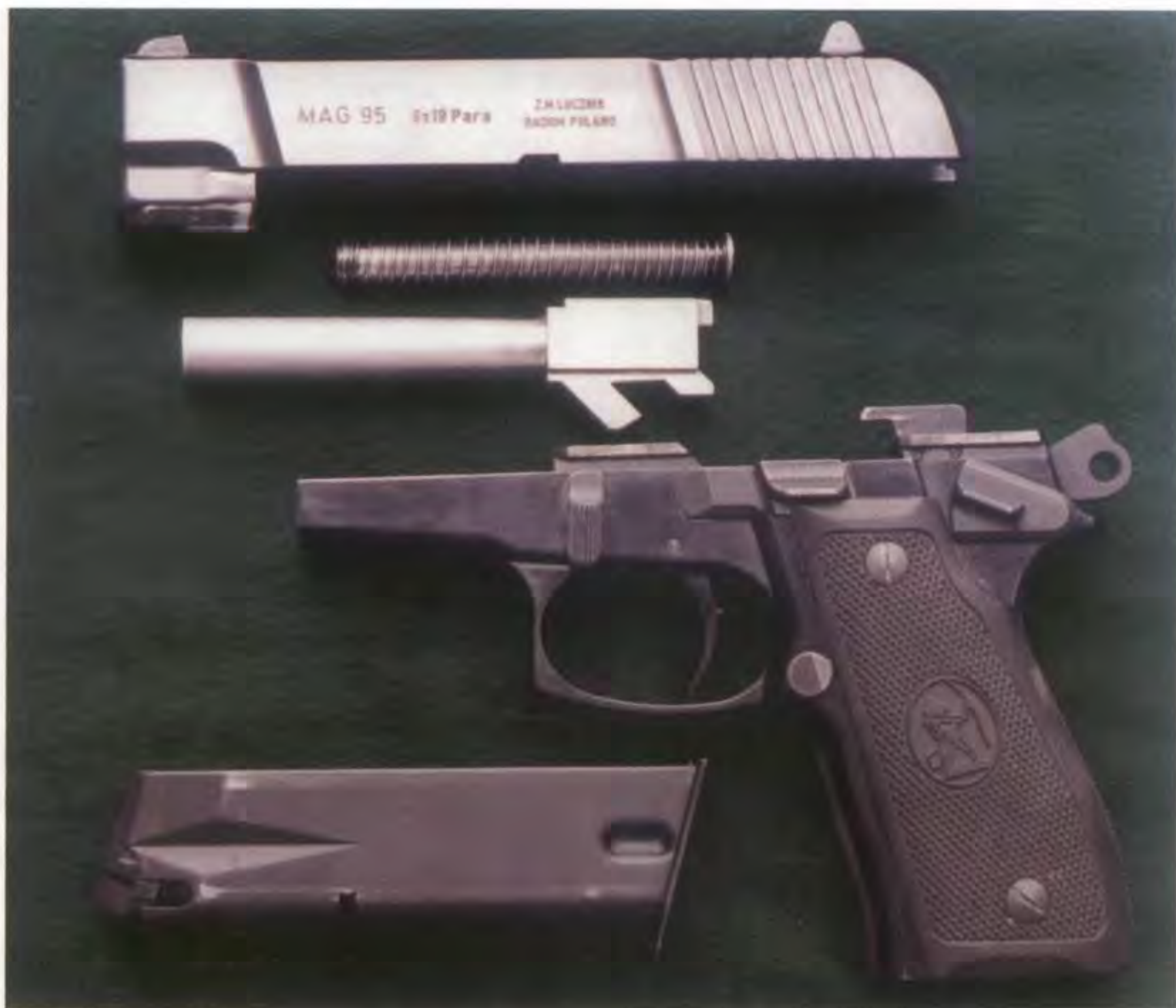
Pistolet MAG-95 częściowo rozłożony (od góry): zamek, mechanizm powrotny, lufa, szkielet, magazynek
