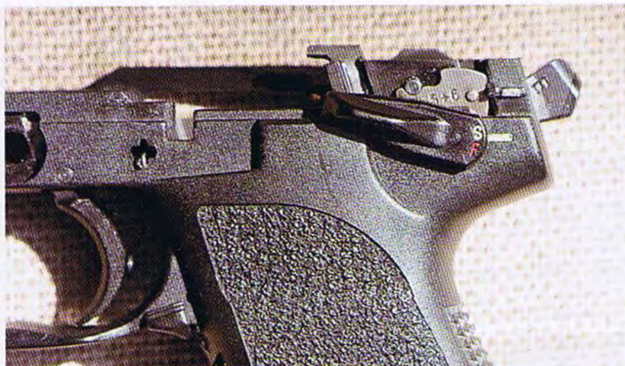
Bezpiecznik i kilka szczegółów jego konstrukcji
