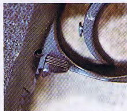
HK mają charakterystyczny zatrzask magazynka. W języku spustowym widoczny regulowany ogranicznik ruchu jałowego
