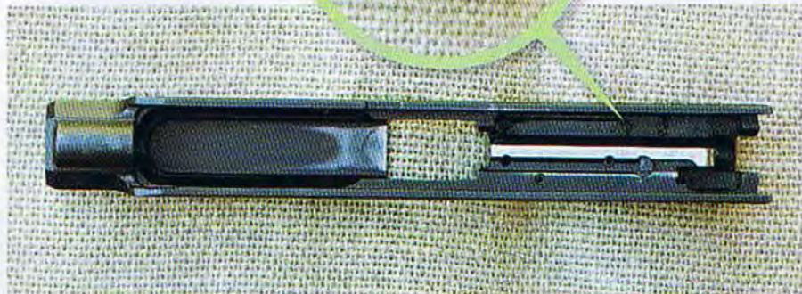
Zamek od spodu i zbliżenie na jego trzon – widoczny tłoczek samoczynnej blokady iglicy: rzecz niezczęsta w sportowych pistoletach
