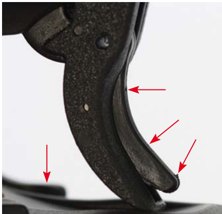
Kolczasty język spustowy kłuje w palec. Za nim widoczne źle spasowane z kabłąkiem i wchodzące w jego światło „skrzydełka” zatrzasku magazynka
