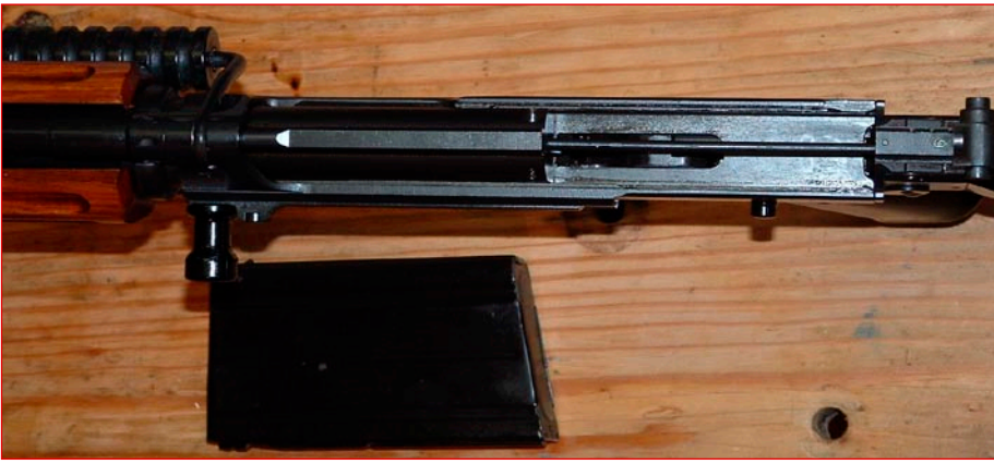
FN FAL – zdjęta pokrywa komory zamkowe
